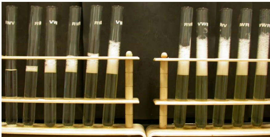
gamme de dilutions décroissantes du décocté (de marron d'Inde) pour la mesure de l'INDICE DE MOUSSE
