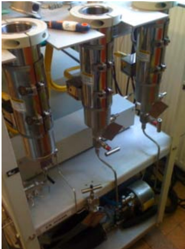
détails extracteur par fluides supercritiques (chambre de macération et détente)
