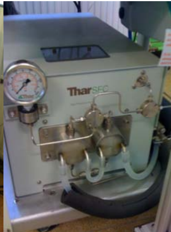
pompe à CO 2
